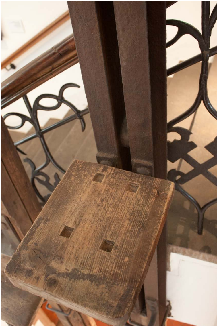
Abb. 11: Eisernes Fahrkunstgestänge aus dem Ludwigschacht.
