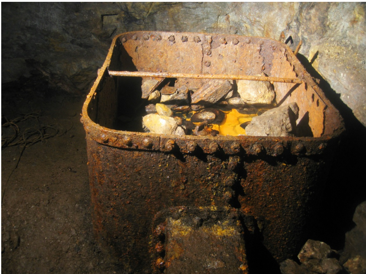
Abb. 4: Eiserne Gegengewichtskästen der Abrahamer Fahrkunst. Foto: S. Weigold
